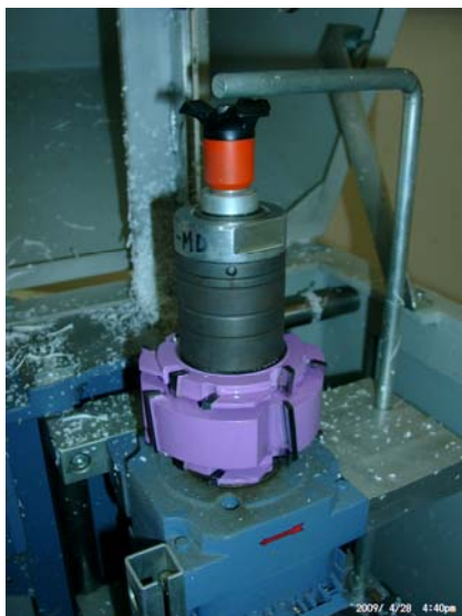
Косозубая фреза с твердосплавными зубьями Н10F и серебряным припоем для обработки профиля рама ф. Rehau
