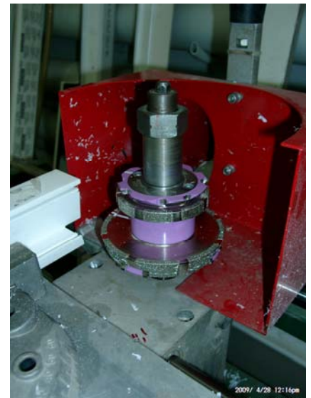
Комбинированная фреза с алмазным напылением ООО «Фест-98» для обработки профиля импост ф. Rehau
