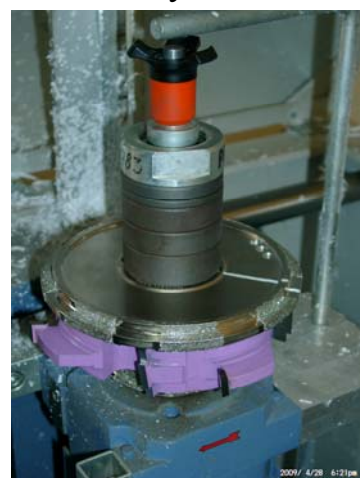
Косозубая фреза с твердосплавными зубьями H10F и серебряным припоем для обработки профиля створка ф. Rehau
