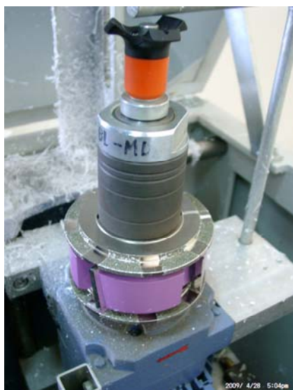
Комбинированная фреза с алмазным напылением ООО «Фест-98» для обработки профиля рама ф. Rehau
